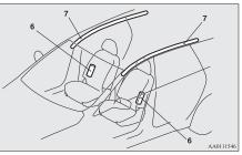
6- Side airbag modules\* 7- Curtain airbag modules\*
